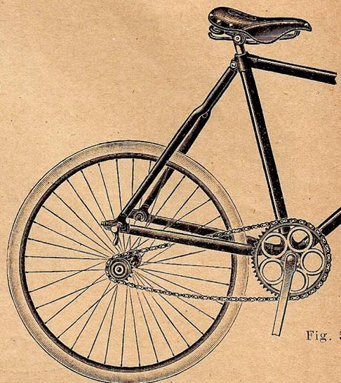
Fig. 5. — Deux écrous à desserrer légèrement, soulever le cadre, et la roue est démontée.
